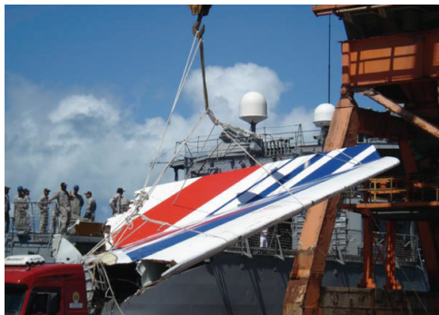
Рис. 89. В ходе поисковой операции был найден и поднят фрегатом ВМФ Бразилии фрагмент вертикального хвостового стабилизатора авиалайнера Airbus A330-203 рейса 447. Author foto: Roberto Maltchik Repórter da TV Brasil
