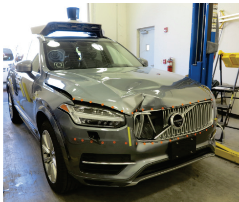
Рис. 72. Оснащенный автопилотом внедорожник Вольво после столкновения. Автор: US National Transportation Safety Board
